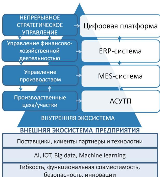
**Рис. 3. Контур автоматизированной процессной модели управления**
